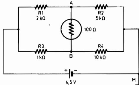
Fig. 9. - Quelle est la valeur du courant dans la résistance de 100  $\Omega$  ?
