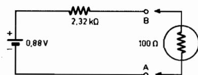
Fig. 11. — Schéma équivalent du pont déséquilibré.
