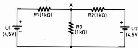
Fig. 5. - Quelle est la valeur de la tension aux bornes de  $R_3$  ?
