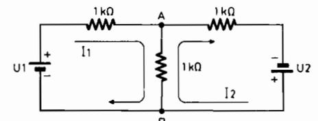
Fig. 7. - Les courants  $I_1$  et  $I_2$  sont égaux et en opposition dans la résistance commune.
