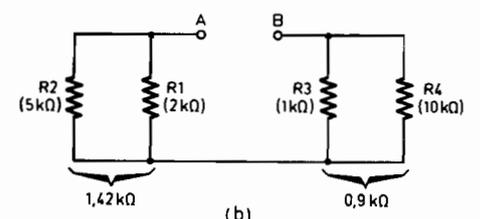
Fig. 10. - Calcul de la résistance équivalente.
