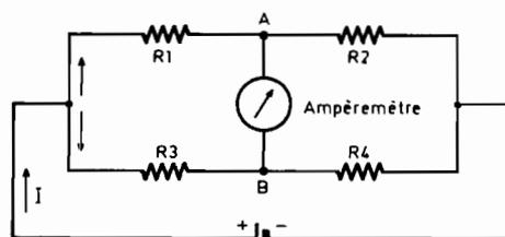
Fig. 8. - Schéma du pont de Wheatstone.
